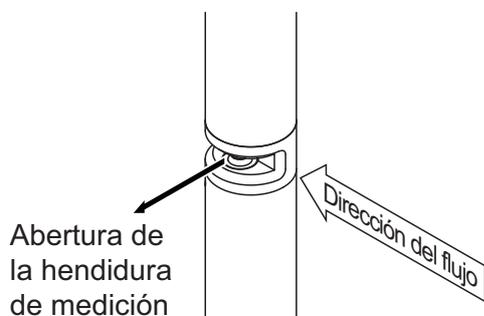
figura 3-2 Instalación vertical
